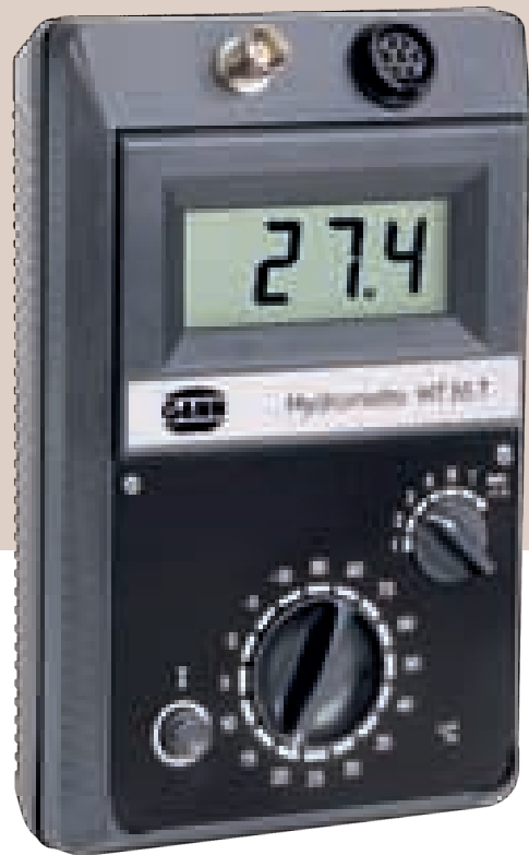
Abbildung 2: Professionelles Holzfeuchte-Messgerät mit Temperaturkompensation
