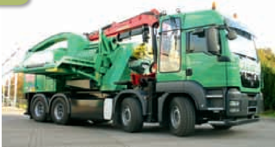
Beim HEM 820 DQ stehen 857 PS fürs Hacken zur Verfügung.
